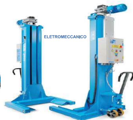
REFERÊNCIA 959 (4 colunas) Capacidade de elevação por coluna 6.5 Ton PVP:
